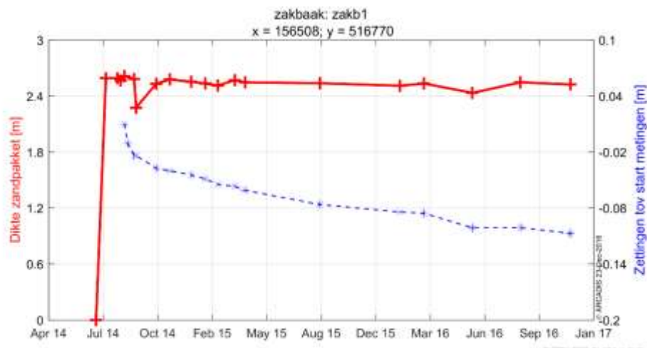
Figuur 6-39 Opgetreden zettingen in relatie met de dikte van het zandpakket in zakb1.
