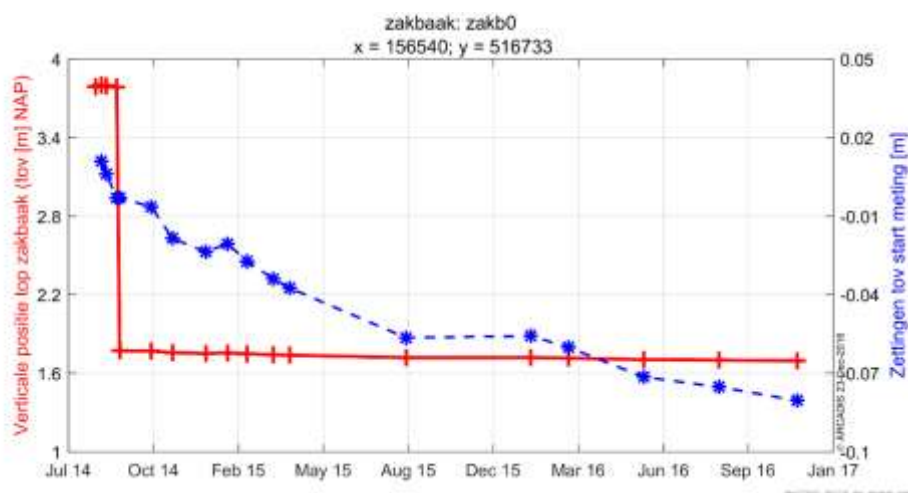
Figuur 6-31 Absolute ontwikkeling top van het zakbaken voor zakb0 (rode lijn), samen met de bijbehorende zetting (blauwe lijn).
