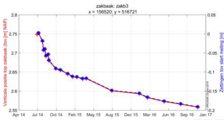
Figuur 6-34 Absolute ontwikkeling top van het zakbaken voor zakb3 (rode lijn), samen met de bijbehorende zetting (blauwe lijn).
