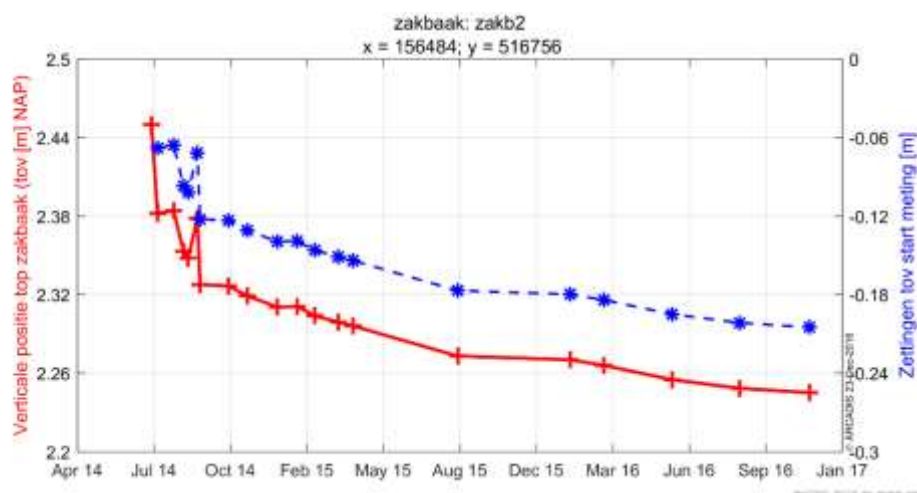
Figuur 6-33 Absolute ontwikkeling top van het zakbaken voor zakb2 (rode lijn), samen met de bijbehorende zetting (blauwe lijn).
