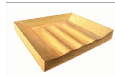
▲ Construir con la Naturaleza está probando un dragado selectivo, dejando crestas artificiales de arena en las zonas de préstamo
