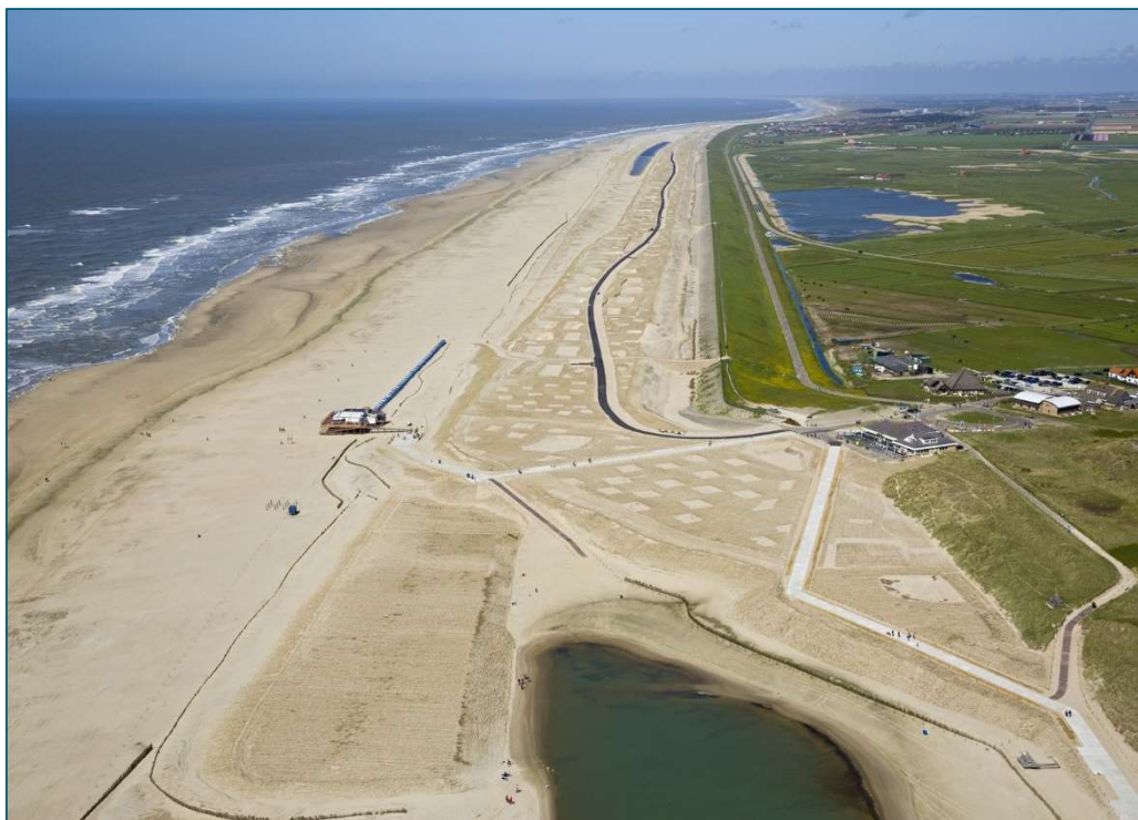
Afbeelding 1.1 Zandige versterking van de HPZ met de ontwerpelementen: helminplant, luwe laagtes (de niet-ingeplante vakken), wilgenschermen en in de verte de vochtige duinvallei. (Foto: www.hoogwaterbeschermingsprogramma.nl )
