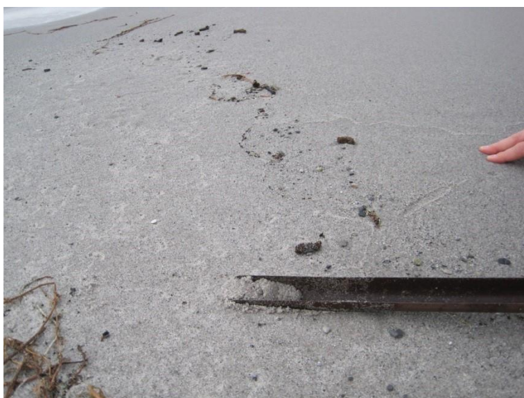
Figuur 7-2 Horizontale monsterneming met grondboor zodat alleen de bovenste 0,5 cm wordt bemonsterd.
