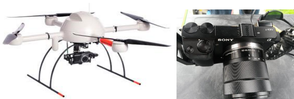
Figuur 2: Microdrone MD4-1000 en Sony alpha NEX-7 camera
