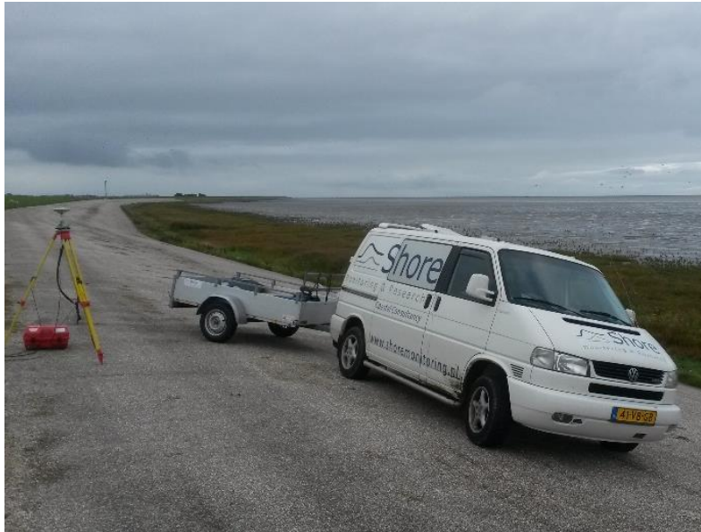
Foto 2: RTK basisstation opgesteld boven referentiepunt.
