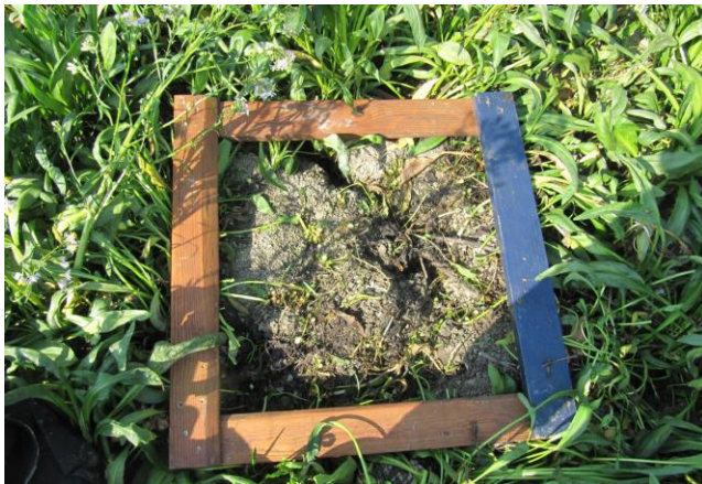
Figuur 3.6. Om de bovengrondse biomassa te verzamelen is een vierkanten houten frame met een intern oppervlak van 0,25 m 2 op het maaiveld geplaatst en alle vegetatie hierbinnen afgeknipt tot 1 cm boven het maaiveld (september 2020).
