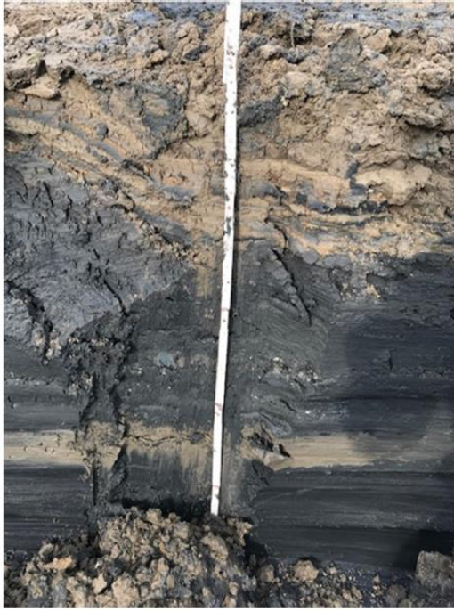
Figuur 15: Afwisseling van zand en klei over de lengte op circa 30 meter van de stortpijp in vak K2.
