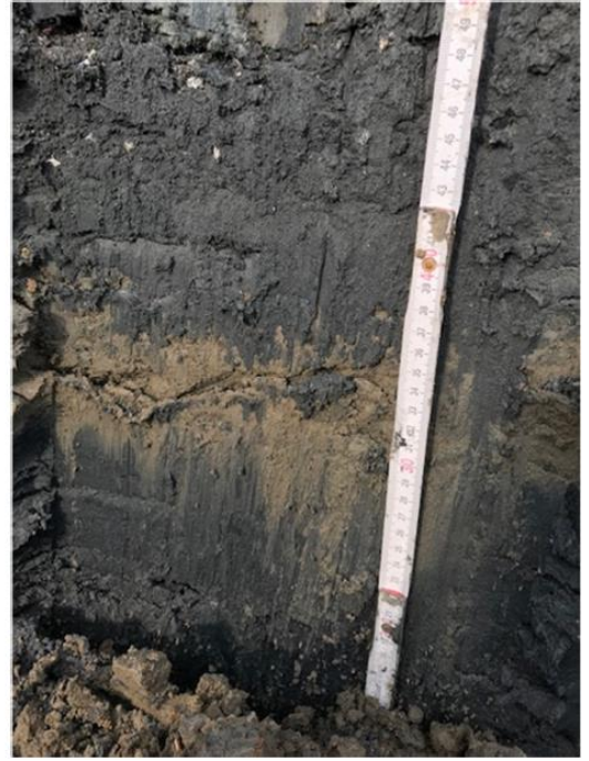
Figuur 15: Afwisseling van zand en klei over de lengte op circa 30 meter van de stortpijp in vak K2.
