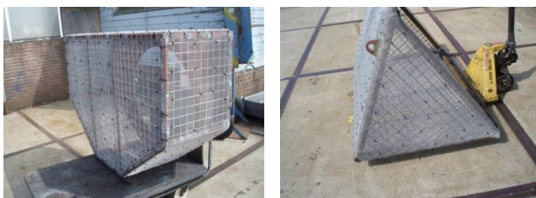
Figuur 1 Gebruikte zuigkorven ter reductie van de instroomsnelheid.
