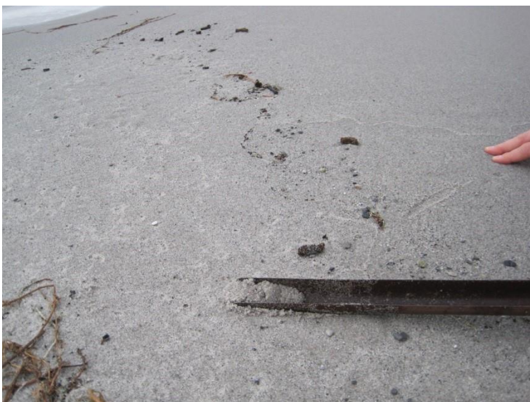
Figuur 7-2 Horizontale monsternamming met grondboor zodat alleen de bovenste 0,5 cm wordt bemonsterd.
